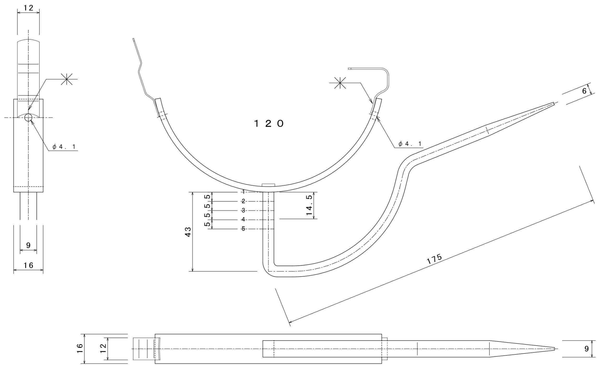
表面処理：爪溶接・カシメ止め後、熔融亜鉛メッキ仕上げのこと。
