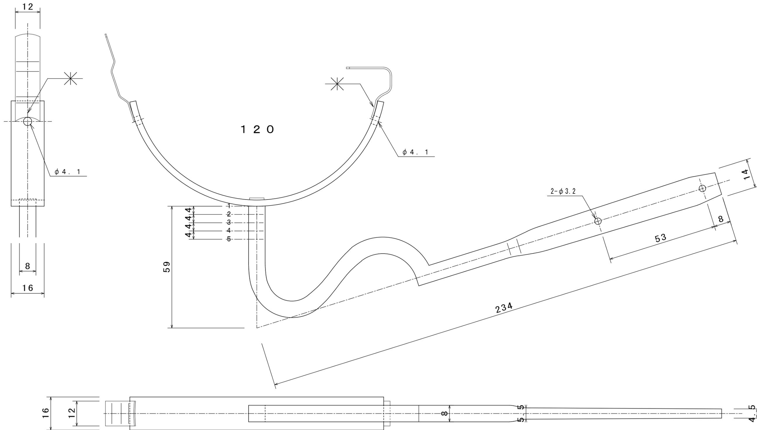
表面処理：爪溶接・カシメ止め後、熔融亜鉛メッキ仕上げのこと。
