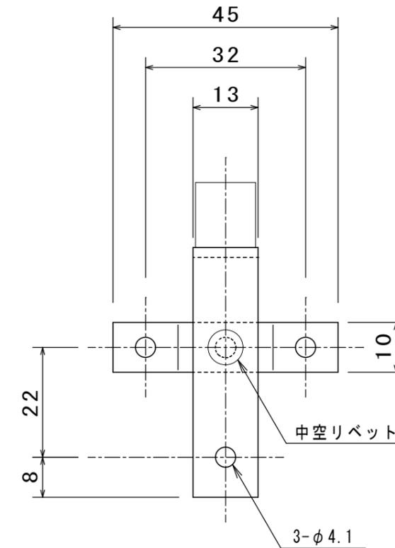
表面処理：爪溶接・トンポリベット止め後、熔融亜鉛メッキ仕上げのこと。
