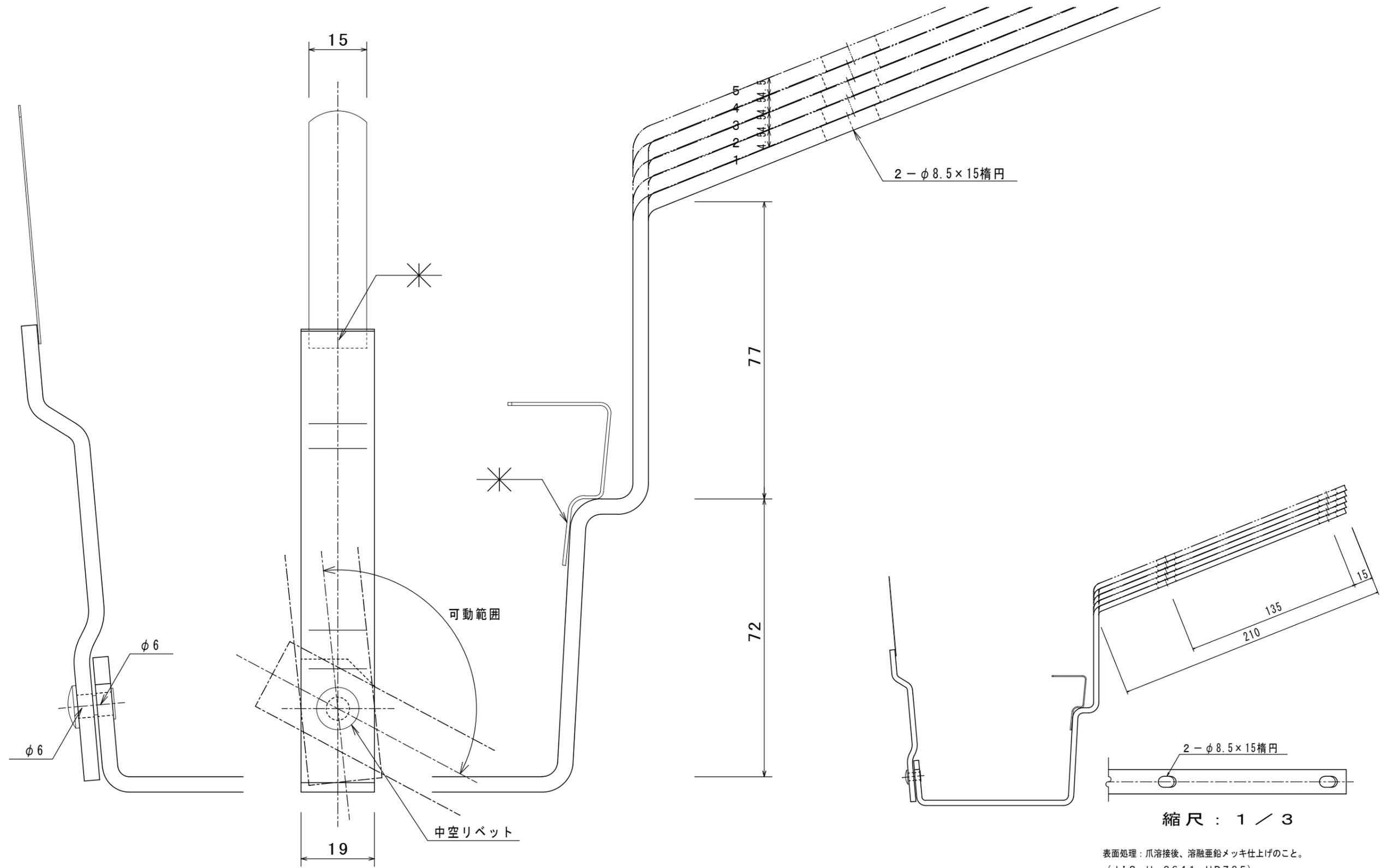
表面処理：爪溶接後、熔融亜鉛メッキ仕上げのこと。
