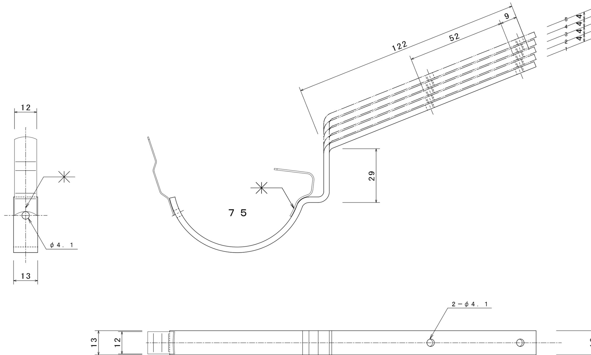
表面処理：爪溶接後、熔融亜鉛メッキ仕上げのこと。
