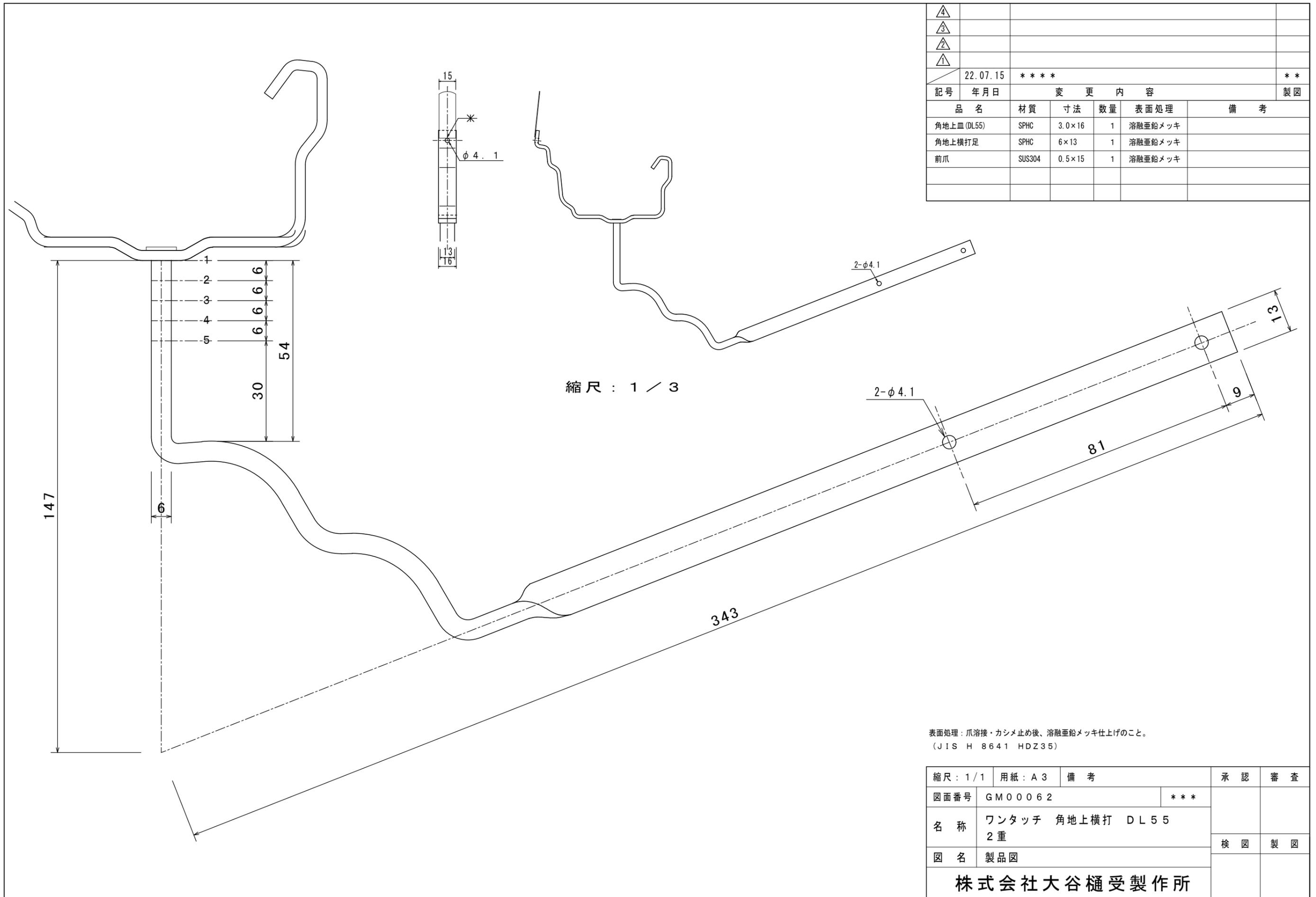
表面処理：爪溶接・カシメ止め後、熔融亜鉛メッキ仕上げのこと。
