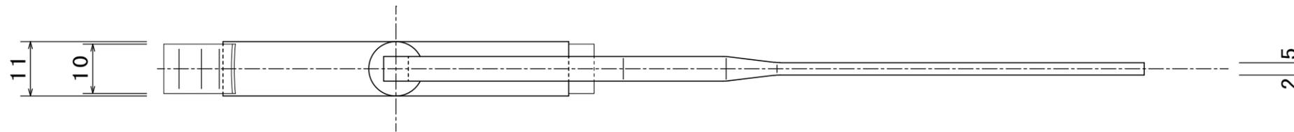
表面処理：爪溶接・カシメ止め後、熔融亜鉛メッキ仕上げのこと。
