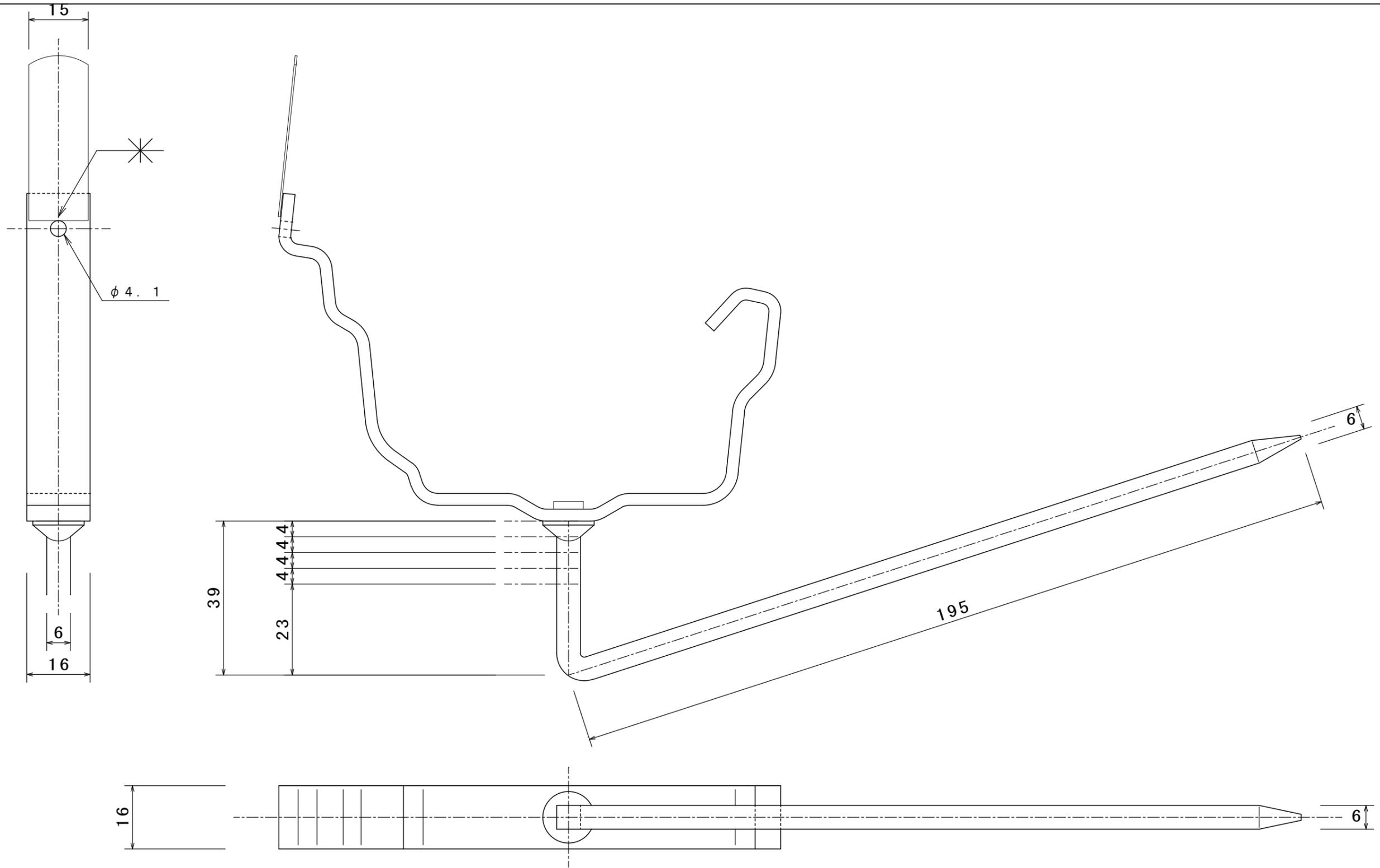
表面処理：爪溶接・カシメ止め後、熔融亜鉛メッキ仕上げのこと。
