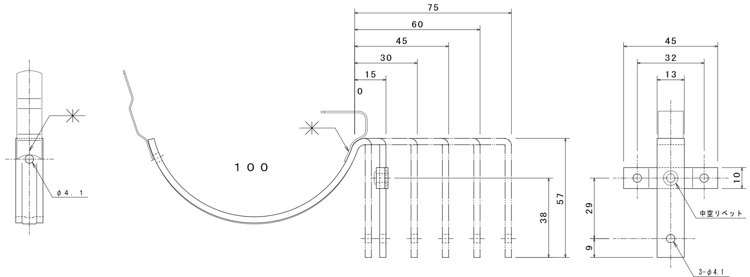
表面処理：爪溶接・トンボリベット止め後、熔融亜鉛メッキ仕上げのこと。
