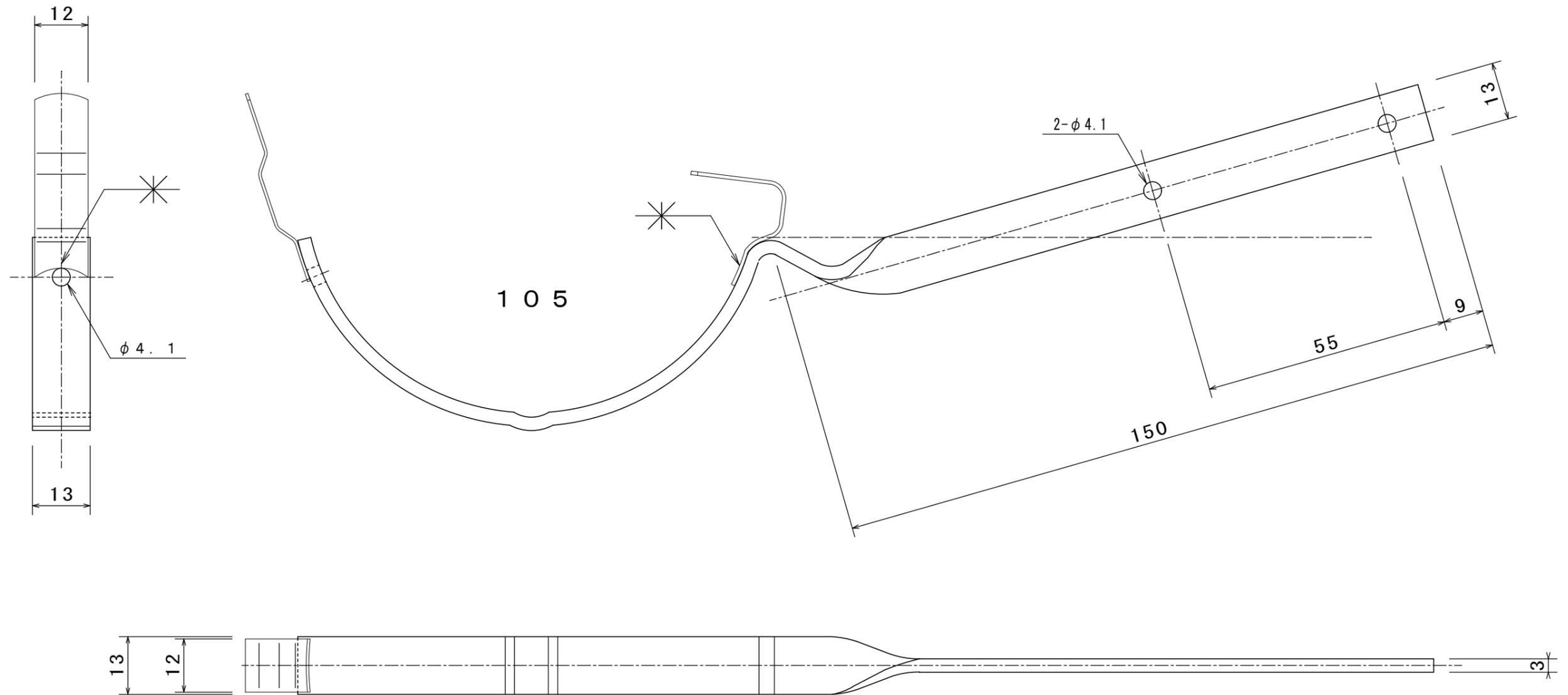
表面処理：爪溶接後、熔融亜鉛メッキ仕上げのこと。
